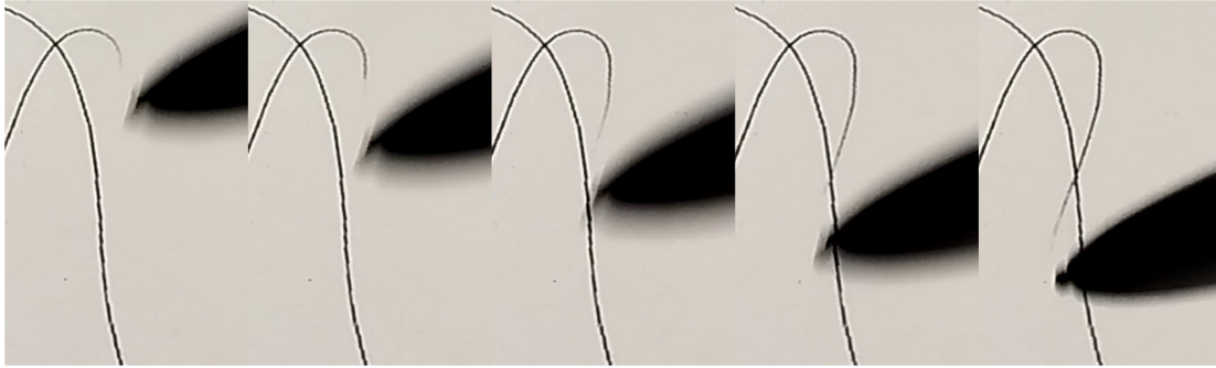
Figura 2.3: Cinci cadre succesive extrase dintr-o filmare proprie realizată la 30 fps pe un dispozitiv BOOX Note 2. Se observă, pe de o parte, o latență de aproximativ un cadru ( \approx 33 ms), iar pe de altă parte, formarea treptată a liniei scrise.
